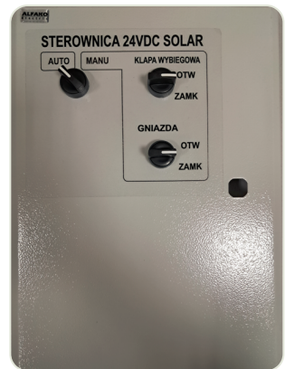
Original-Bedienfeld (Beschriftung: AUTO/MANU, KLAPA WYBIEGOWA = Auslaufklappe, GNIAZDA = Steckdosen, OTW/ZAMK = Auf/Zu)
