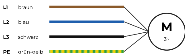
Abb. 3: Aderbelegung der Netzleitung
